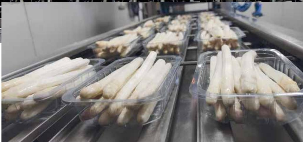
Espárragos de Navarra frescos y pelados en la maquinaria que prepara en bandejas de atmósfera protegida
