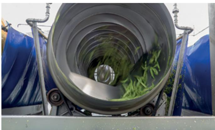
Tras las primeras fases de limpieza, la máquina despuntadora separa las impurezas y corta las puntas de las judías
