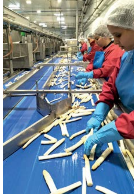
Línea de revisión donde se comprueba el correcto pelado del espárrago
