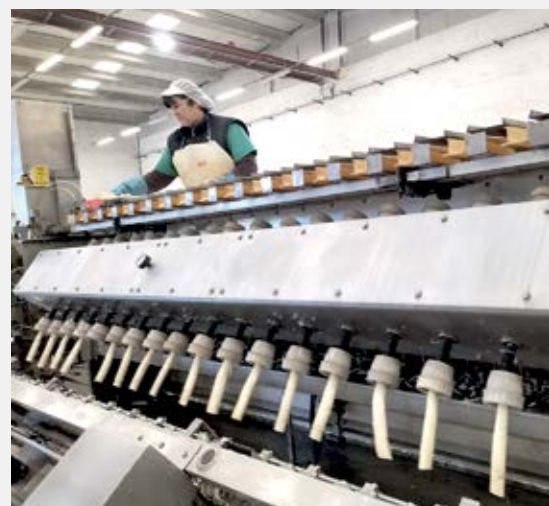
Empleada del CHC colocando los espárragos en la máquina peladora
