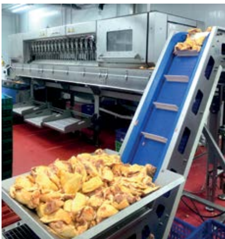
La nueva maquinaria optimiza el proceso de deshuesado, consiguiendo carne de la máxima calidad y minimizando el desperdicio alimentario
