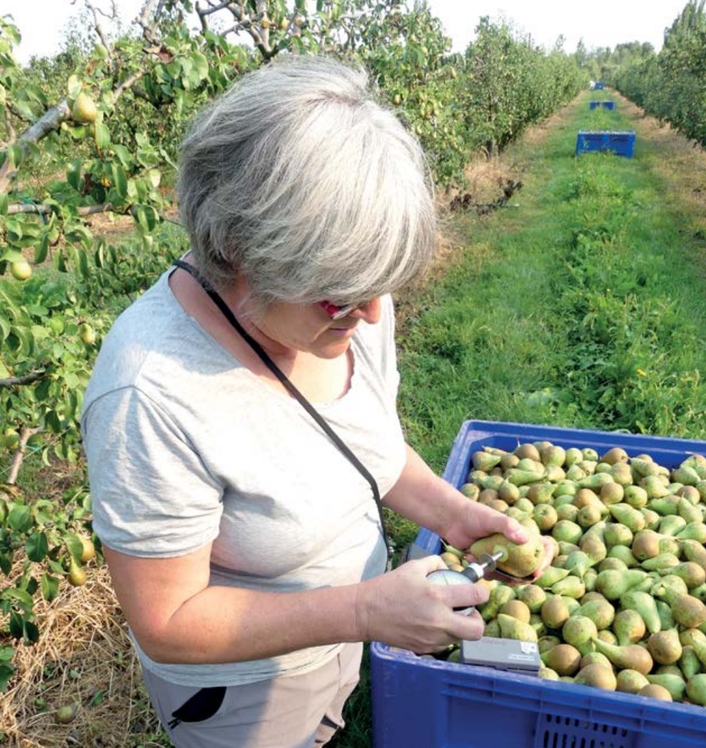
Llosar Tena midiendo la dureza de la pera
