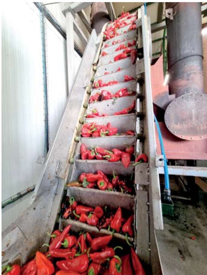
Los pimientos subiendo a los hornos tubulares
